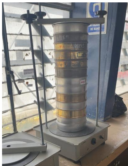
Figura 8.-Tamices en forma descendente en la tamizadora
