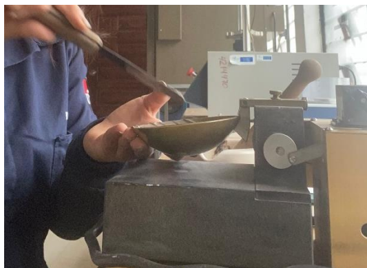
Figura 6.-Determinación del Limite liquido Método de casa grande
