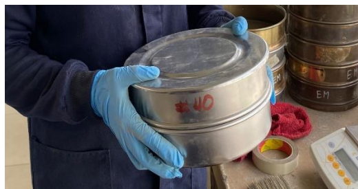
Figura 5.-Tamización del agregado por el tamiz #40
