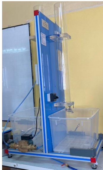
Figura 9.-Permeámetro de Drenaje
