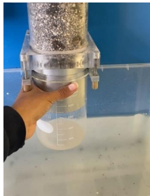
Figura 10.- Medición del caudal
