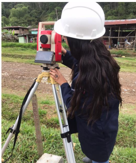
Ilustración 1. Toma de puntos del levantamiento topográfico.
