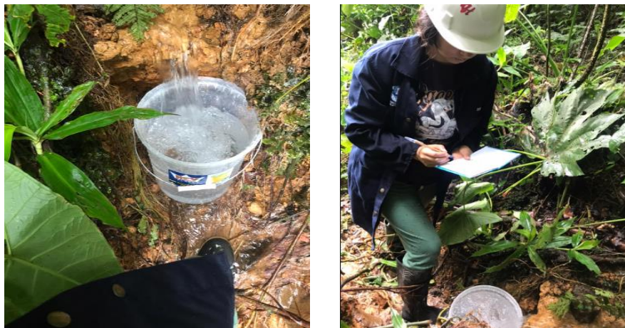
Ilustración 3. Medición del caudal de captación.
