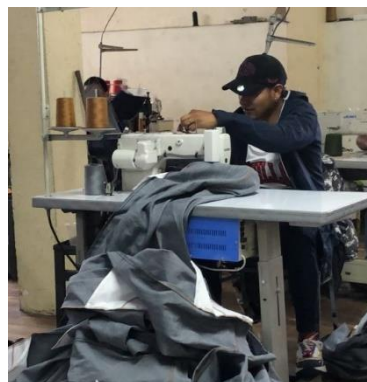
Figura 33. Riesgo de Vibraciones (Máquina recta).
