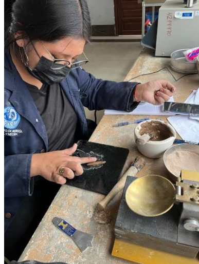
Fig 20: Realización de rollitos para determinación de límite plástico
