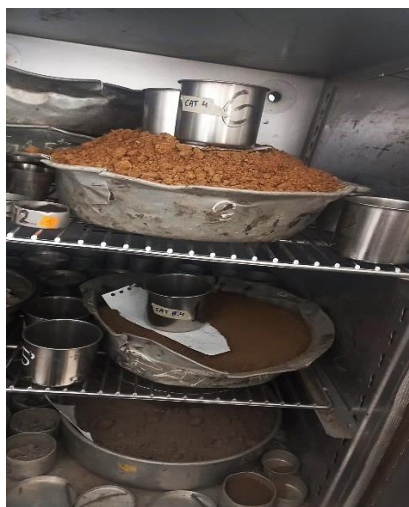
Fig 13: Colocación de muestras en el horno
