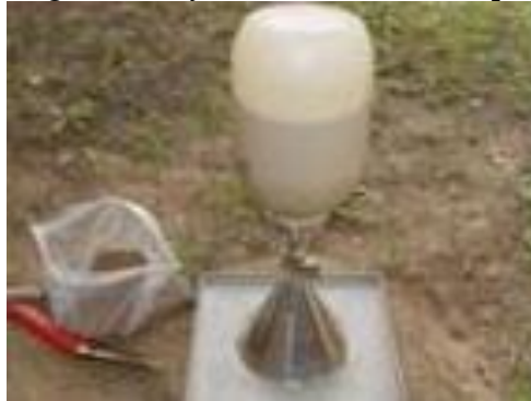
Fig 14: Ensayo de Densidad de campo
