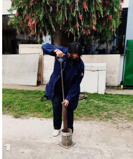
Fig 21: Ensayo de Proctor modificado “B”
