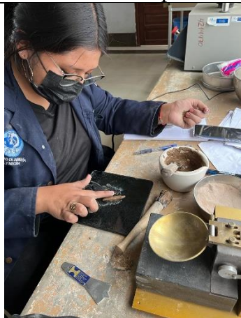
Ensayo Límite Plástico.
