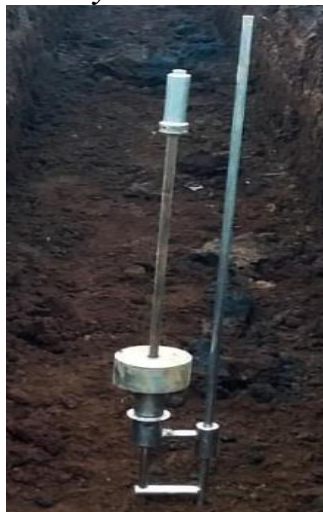
Fig 15: Ensayo de Densidad de campo
