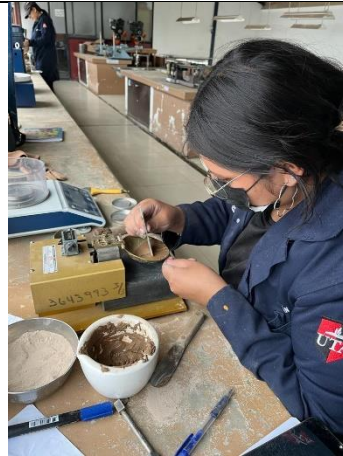
Ensayo Límite Líquido.
