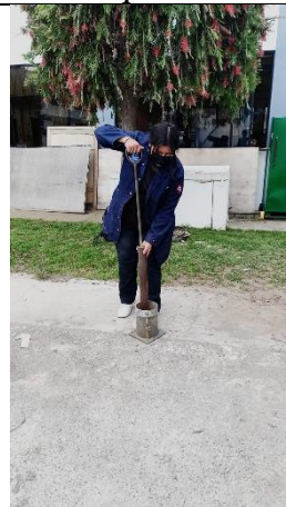
Compactación del suelo, ensayo Proctor.
