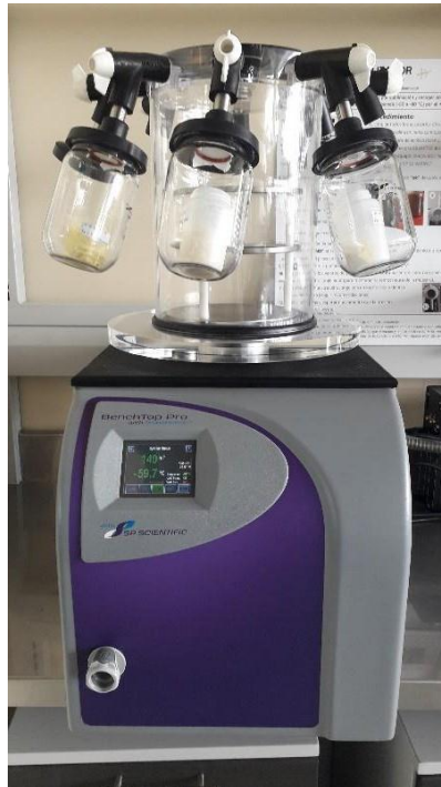
Figura 15. Liofilización de los extractos proteicos
