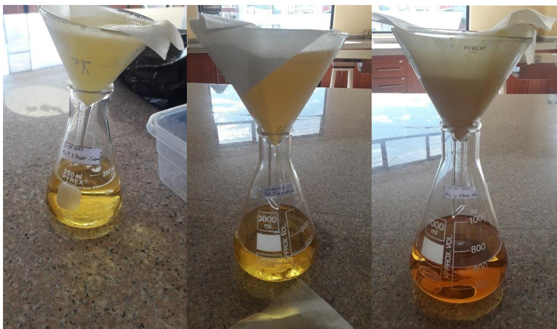
Figura 14. Filtración del precipitado
