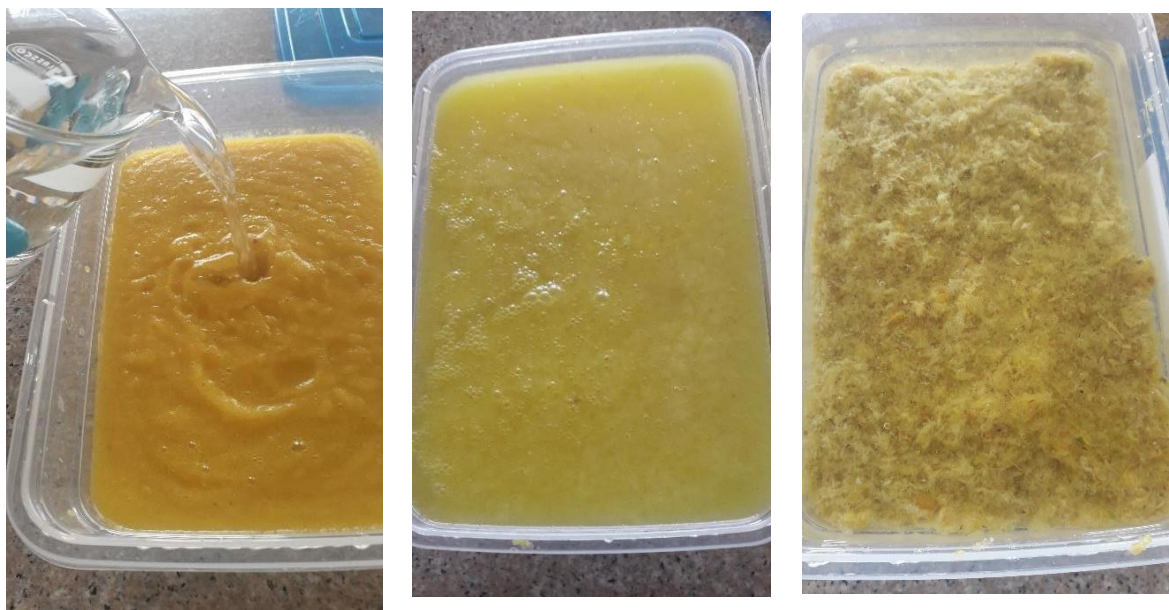
Figura 11. Precipitación del extracto de homogeneizado con etanol al 96%
