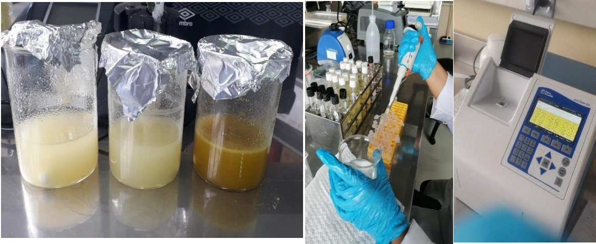
Figura 16. Preparación de soluciones, diluciones y medida de absorbancia en el espectrofotómetro
