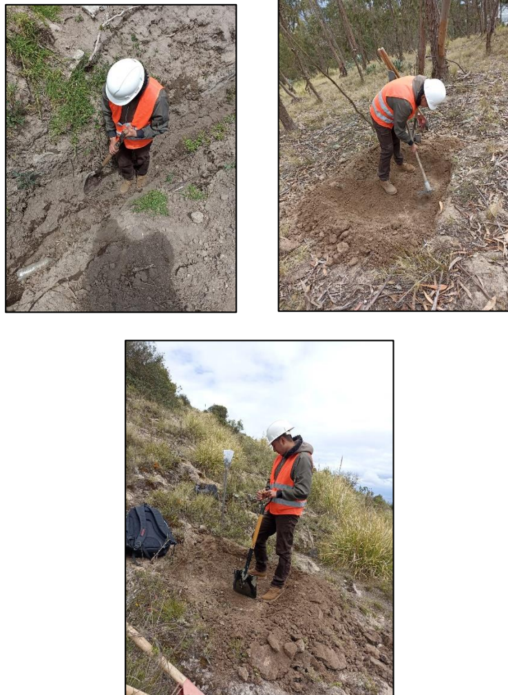
Figura N°12. Extracción de muestras (calicatas)
