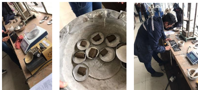
Figura N°15. Ensayo de Límites de Atterberg
