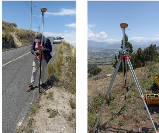
Figura N°1. Levantamiento Topográfico. Equipo RTK
