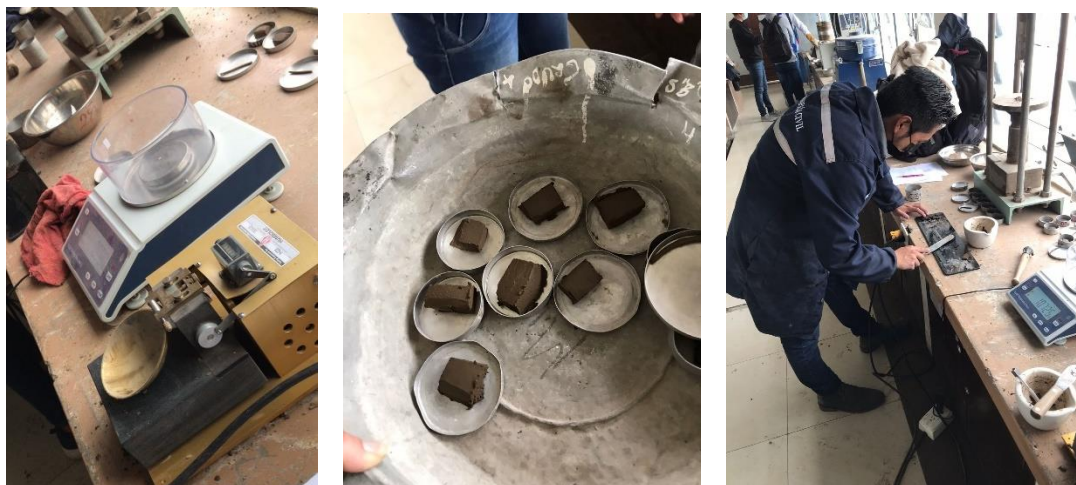
Figura N°3. Ensayo de Límites de Atterberg
