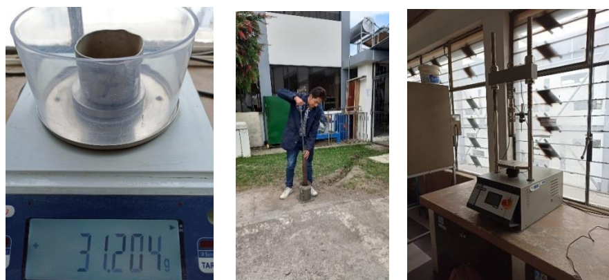
Figura N°4. Ensayo Proctor y CBR
