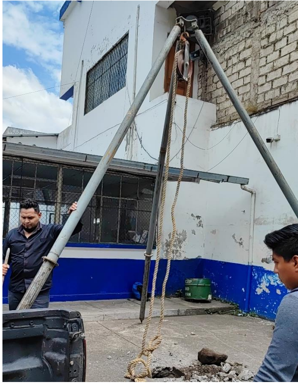
Fotografía 3. Equipo montado para extracción de muestra
