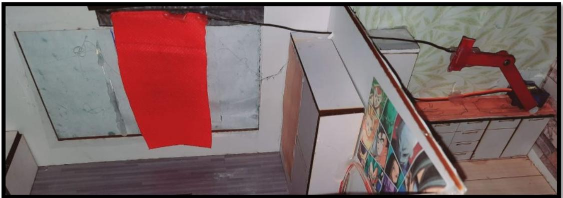
**Figura 49.-** Instalación del servomotor para control de persiana del cuarto.
