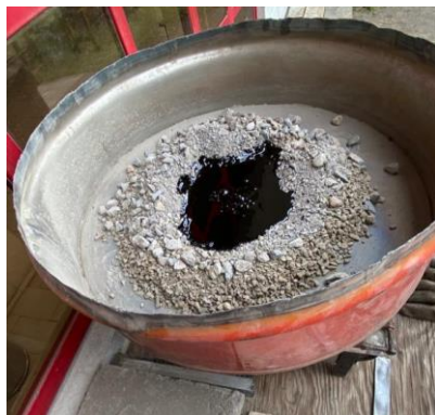
Preparación de los agregado y vertido de asfalto (140°C)
