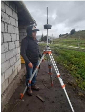
Nivelación de Gps diferencial
