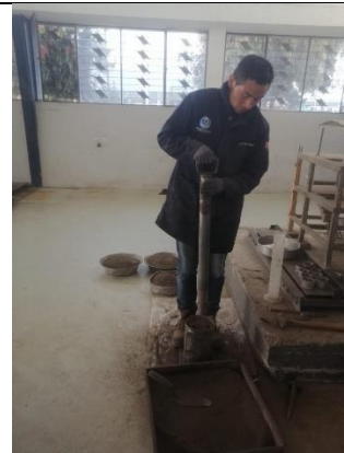
Compactación de la muestra
