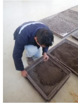
Tamizado para el ensayo de CBR
