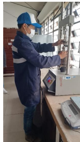
Ensayo de penetración
