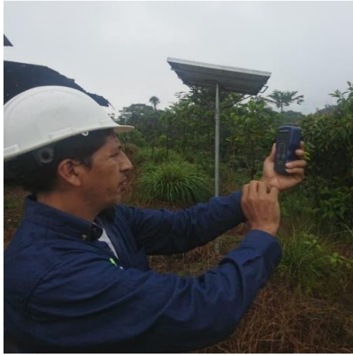
Figura 5-2: Medición de irradiancia solar, dirección al sol.
