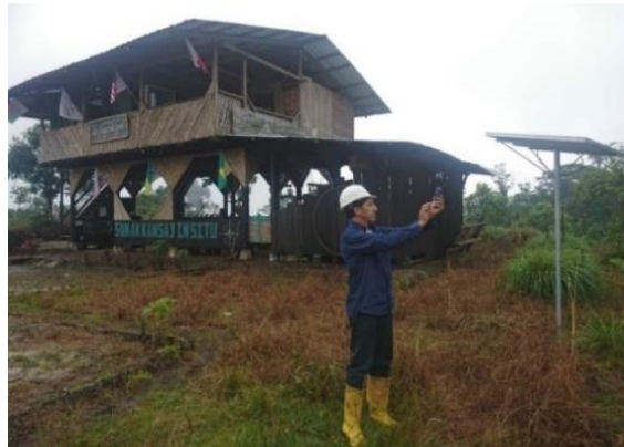
Figura 5-3: Medición de radiación solar con el piranómetro digital.
