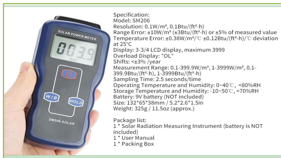
Figura 5-5: Características técnicas del piranómetro digital SM206-SOLAR.
