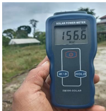
Figura 4-15: Piranómetro en medición de radiación solar (W/m 2 ).
