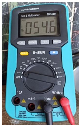
Figura 4-17: Medición de tensión en corriente continua CC.
