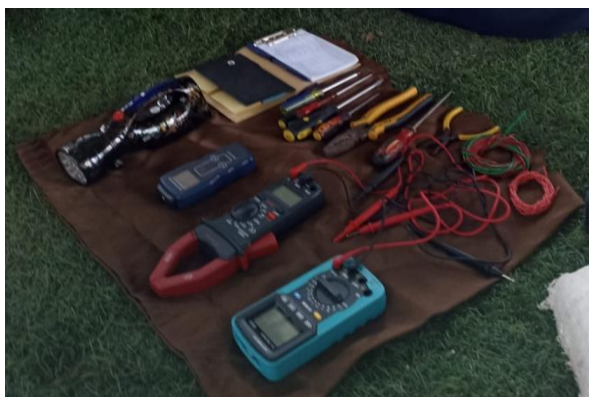
Figura 4-18: Herramientas y equipos empleados en el mantenimiento preventivo.
