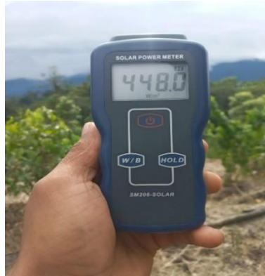
Figura 5-4: Instrumento de medida de radiación solar, piranómetro SM206-SOLAR.
