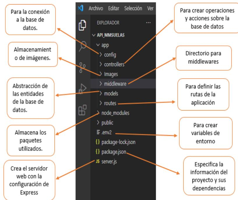
*Figura 22: Estructura del back-end del proyecto con Express*
