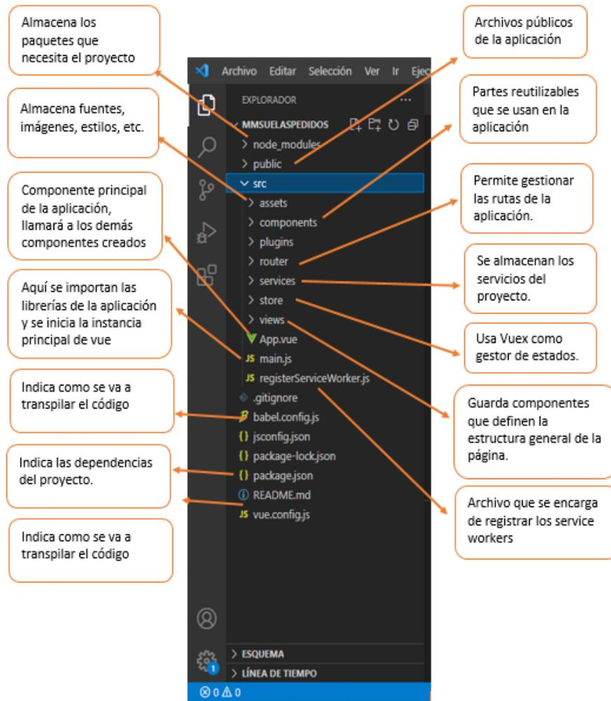
Figura 21: Estructura del front-end del proyecto con Vue
