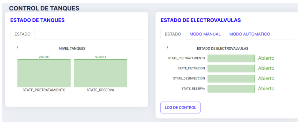
Figura 63 Control de tanques y estado.
