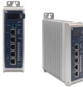
Figura 96 PLC CPL410 basado en Linux [104].
