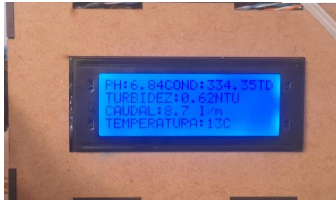
Figura 112 valores capturados pH, conductancia, temperatura, turbidez y caudal.
