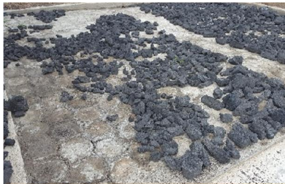
Figura 21 Piroclásticos finos para filtración de agua [57].
