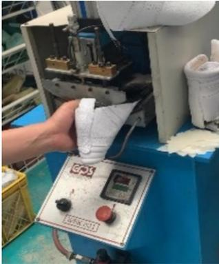
Figura 20. Activación puntera
