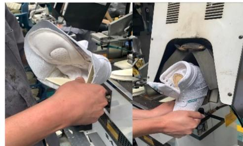
*Figura 19. Inserción de contrafuertes*
