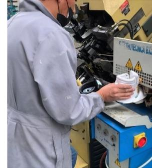
Figura 24. Reactivación punta
