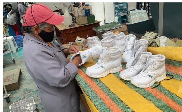
*Figura 30. Terminado y empaquetado*
