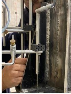
Figura 3- 3. Sensor LVDT para la medición del desplazamiento vertical de la placa base [34].
