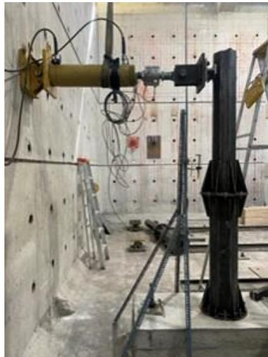
Figura 2- 10. Ensayo de carga lateral con muro y losa de reacción en una estructura metálica Normas aplicadas en el ensayo de carga lateral del monopolo de telecomunicaciones [34].
