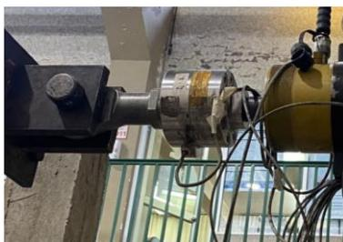
Figura 3- 1. Acople de la celda de carga entre el cilindro y la parte superior del espécimen de prueba [34].
