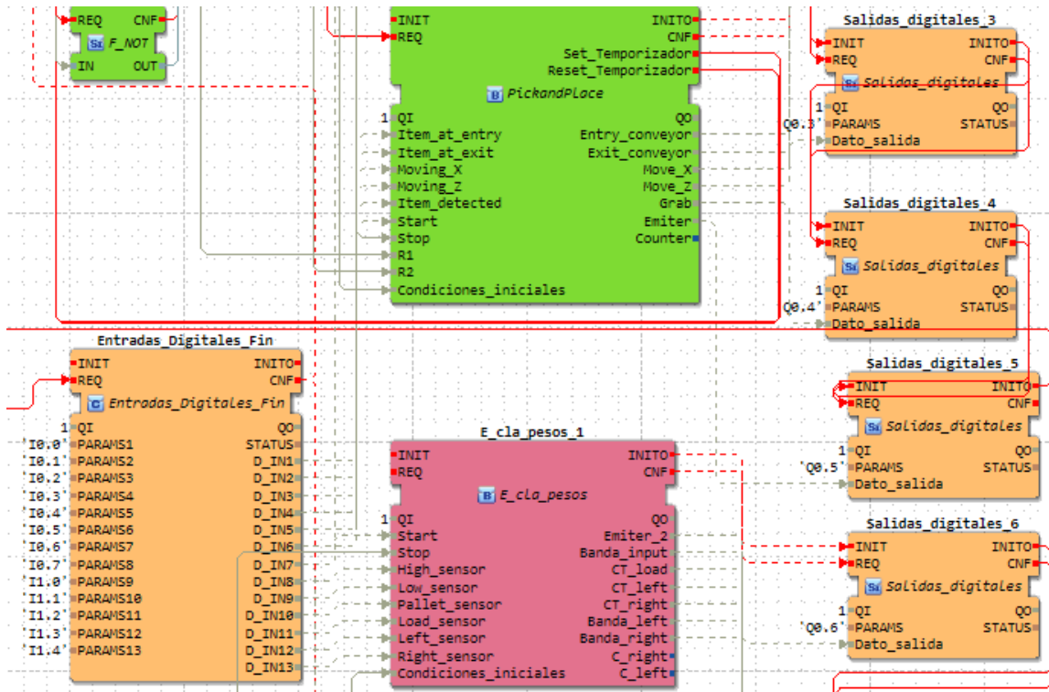
Figura 18. Estructura del sistema de control de los procesos y la adquisición/envío de datos.
