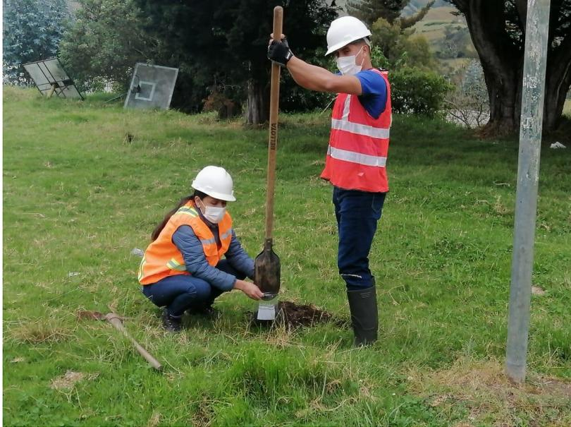
(colocación de muestra recolectada en bolsas de polietileno)
