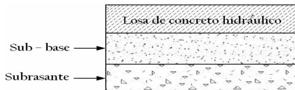
Figura 20. Capas que conforman un pavimento rígido
