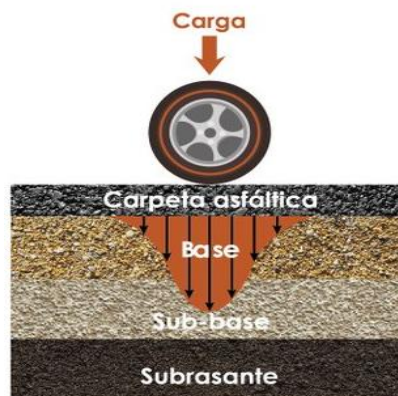
Figura 19. Estructura del pavimento flexible
