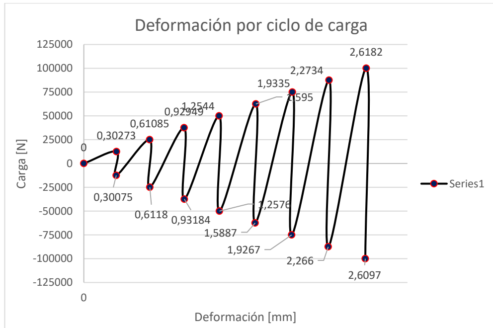
Figura 4- 9. Deformación por ciclos de carga para el amortiguador híbrido AMH-03 En la Figura 4-9 se presentan los resultados de deformación por ciclo de carga para el tercer modelo de amortiguador se observa un valor máximo de desplazamiento de 2,61 mm que ocurre cuando se aplica una carga de 100 kN, como el conjunto de placas no ha superado el S_{ut} del material como se detalló en la tabla de resultados de esfuerzos puede continuar deformándose, sin embargo, las placas no podrían recuperar su forma original dado que en dicho punto trabajan en el rango plástico.
