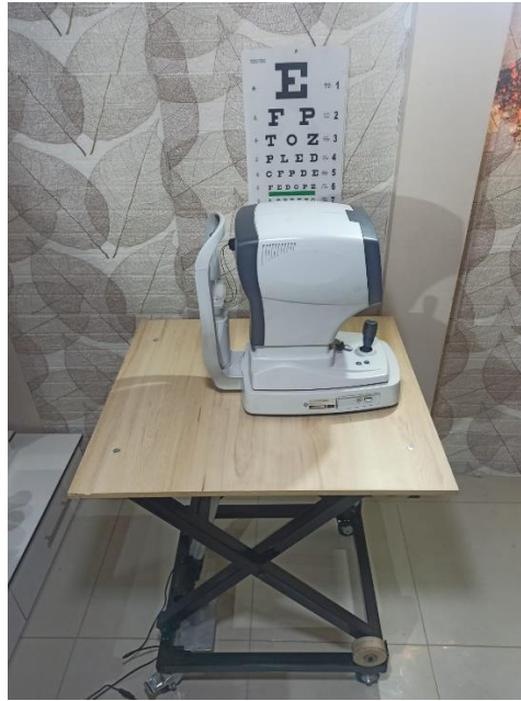
Figura 82. Plataforma elevadora móvil con el refractómetro queratómetro – Posición plegada.
