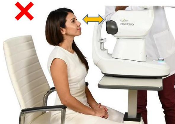
Figura 04. Posicionamiento erróneo entre los soportes del refractómetro queratómetro y la pupila del ojo del paciente [8].
