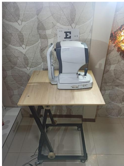
Figura 83. Plataforma elevadora móvil con el refractómetro queratómetro – Posición desplegada.
