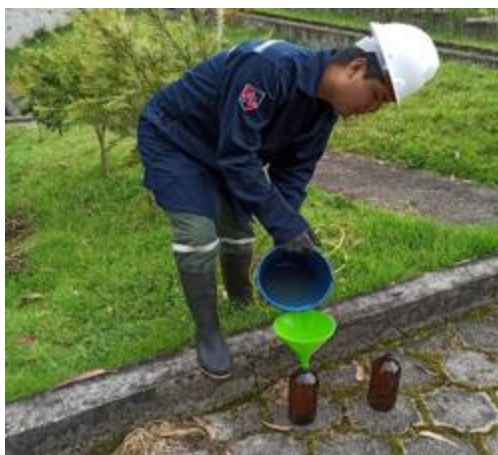
Figura 4 Toma de muestras de entrada y salida de la PTAR
