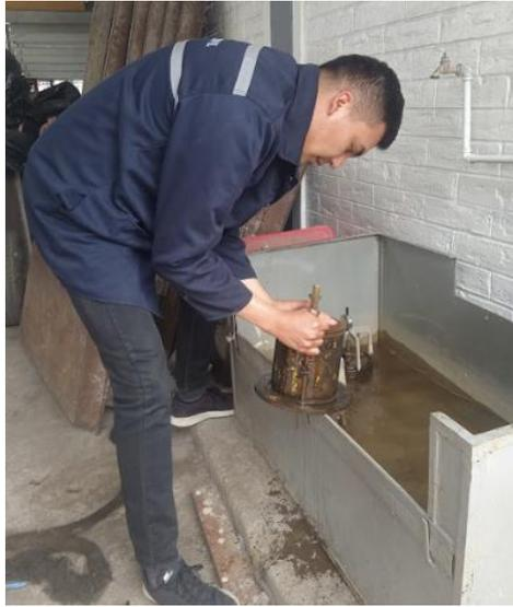
**Figura 67.** Sumergir moldes para ensayo posterior de CBR
