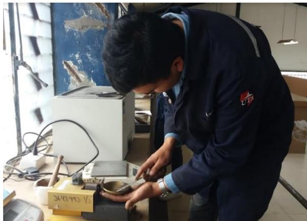
**Figura 64.** Ensayo para Límites de Atterberg
