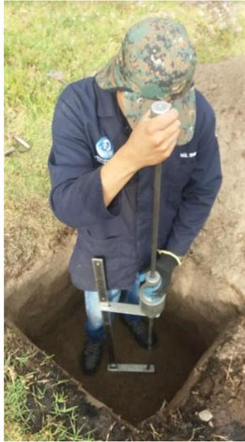
**Figura 60.** Ensayo DCP en campo
