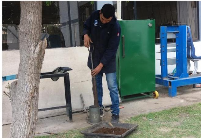
**Figura 66.** Ensayo de Proctor Modificado
