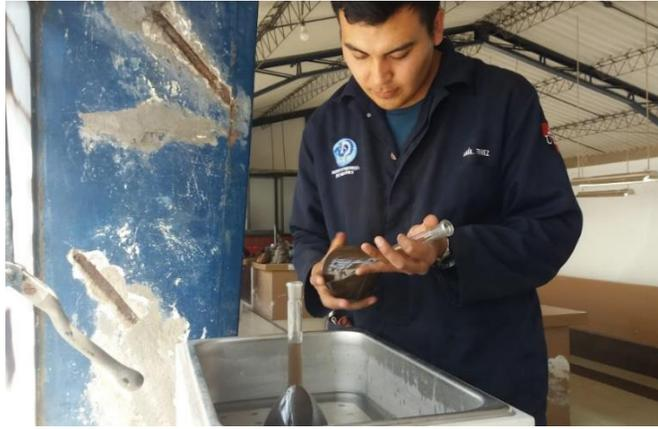
**Figura 65.** Ensayo de Gravedad Específica de sólidos
