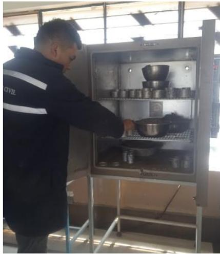
**Figura 62.** Ensayo de Contenido de Humedad Natural
