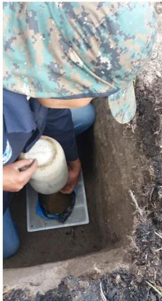
**Figura 61.** Ensayo Cono y Arena
