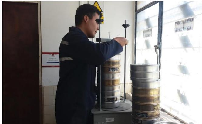
**Figura 63.** Ensayo de Granulometría
