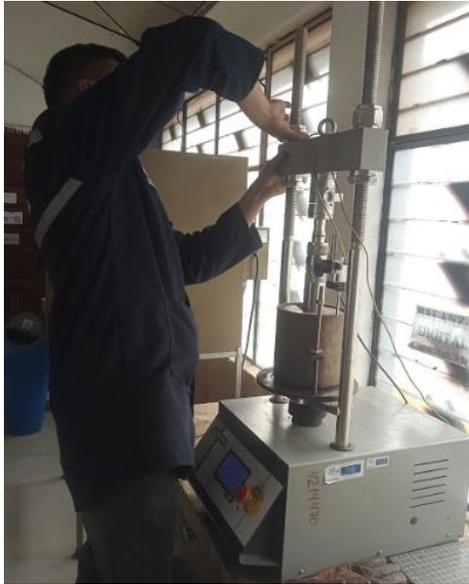
**Figura 68.** Ensayo en máquina Multispeed para CBR
