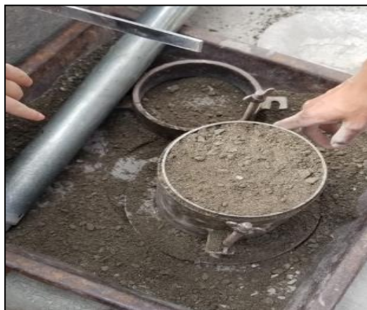
Fig. 27 Compactación de suelos
