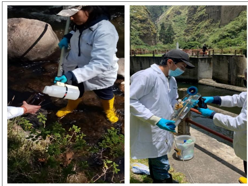
Figura 6. Recolección de muestras. (A) barra muestreador, (B) botella Van dorn.
