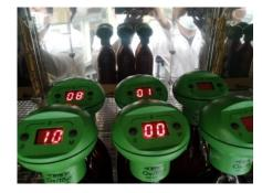
Nota. Determinación de DBO con el equipo OxiTop para análisis inhibitorios.
