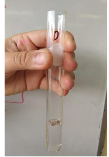
Figura D19: Prueba negativa de presencia metanol, tratamiento A_1B_0R_2
