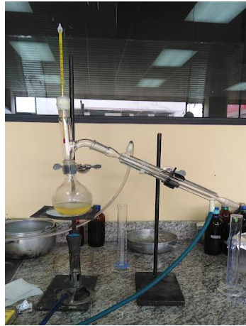
Figura D12: Destilación alcohólica
