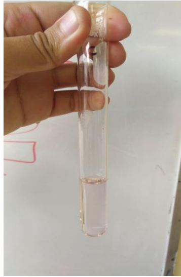
Figura D18: Prueba positiva de presencia metanol, tratamiento A_1B_0R_1
