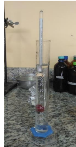
Figura D13: Determinación de grado alcohólico
