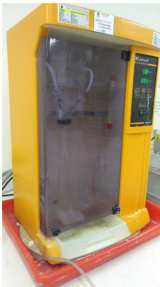
Figura D14: Equipo para destilación con arrastre de vapor para determinación de acidez volátil
