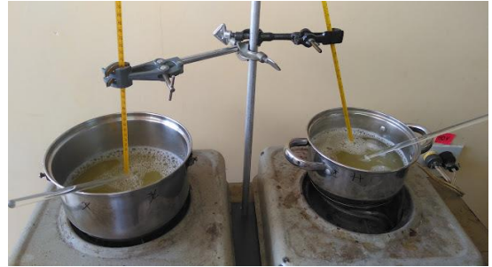
Figura D10: Pasteurización lenta de las bebidas fermentadas
