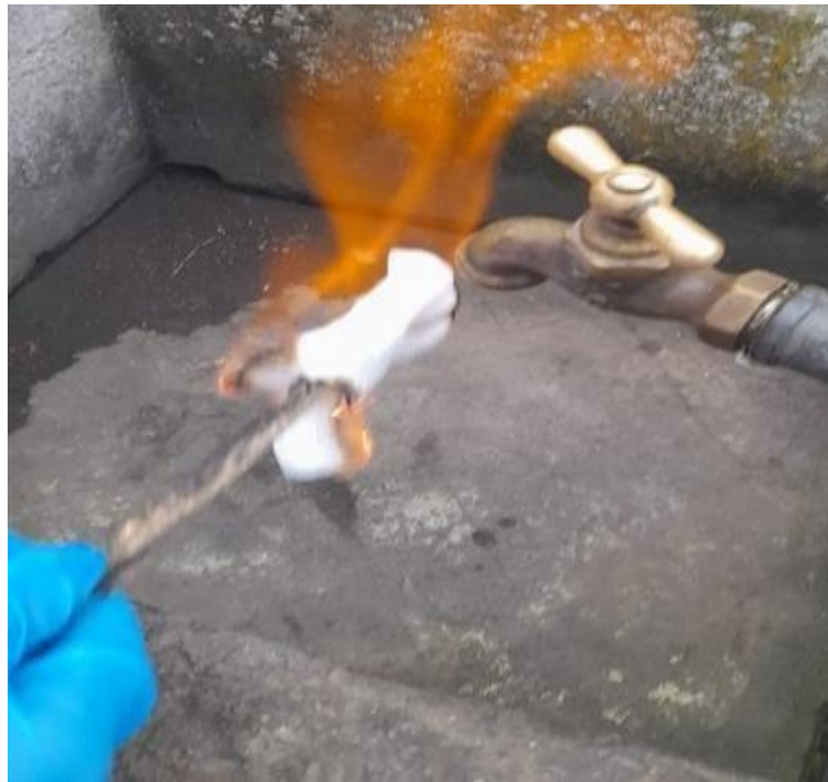
Anexo 3 Toma de muestras en la red de distribución de agua domiciliaria Toallo el Quinche.
