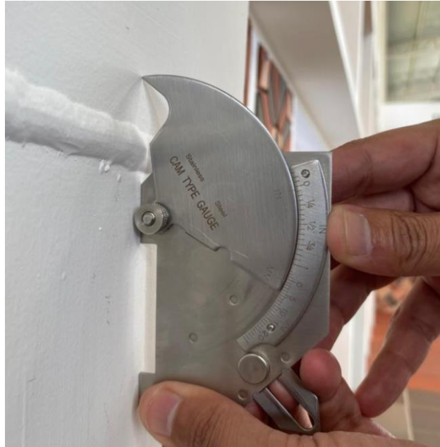
Figura 4- 66: Desalineación de la unión de las chapas de la columna
