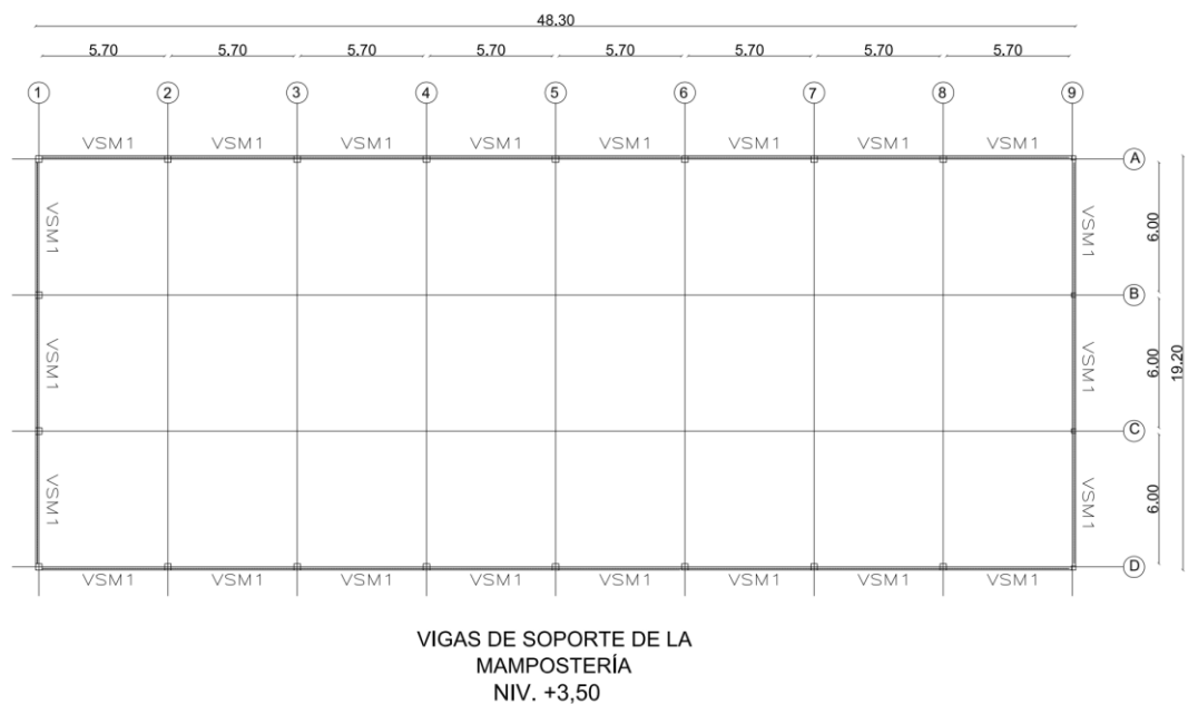
Figura 4- 22: Configuración en planta del sistema estructural
