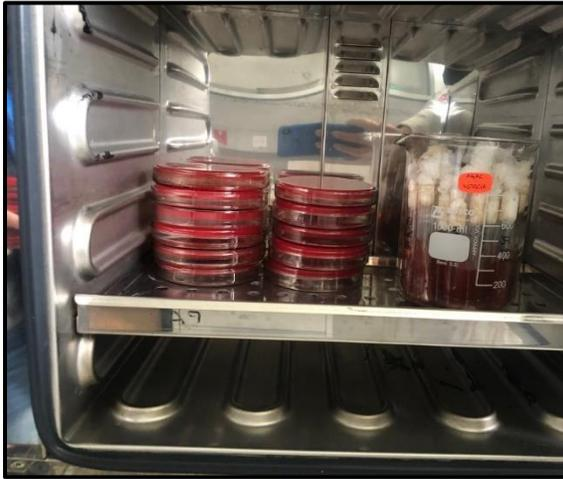
**Foto 8: Placas y tubos de ensayo con agar TSI en el proceso de incubación**
