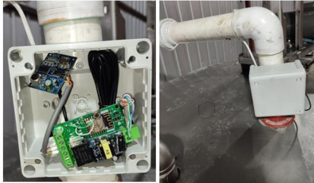
Figura - 68- Ubicación de la caja que contiene el módulo Esp8266 y el módulo de sensor ultrasónico
