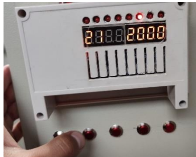
Figura - 79- Configuración del Parámetro 21 - cantidad de litros a ingresar en el tanque de 10000 L
