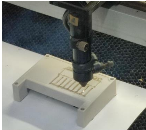
Figura - 74- Corte con láser de la caja para el módulo Tm1638
