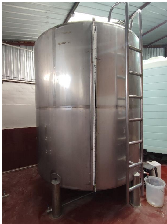
Figura - 8- Tanque se mezcla con capacidad de 10000 L
