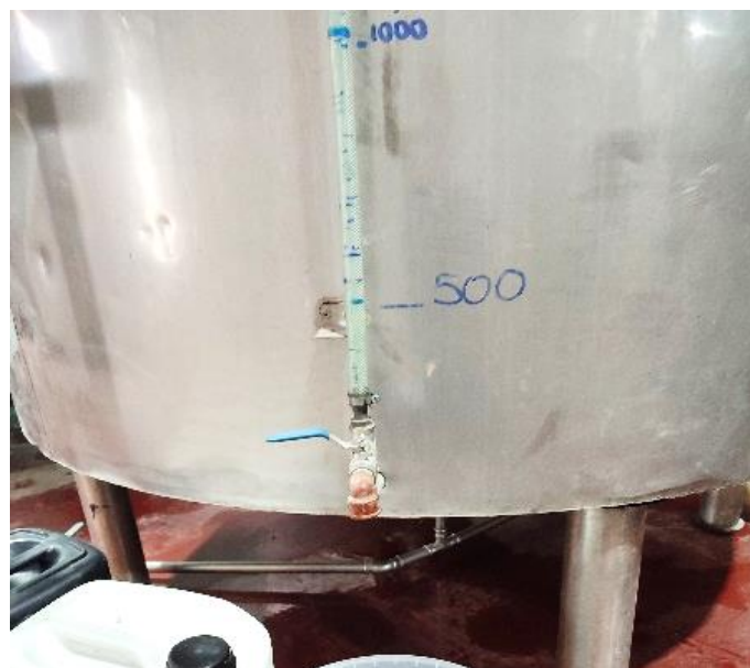
Figura - 13- Líneas marcadas en los tanques de mezcla
