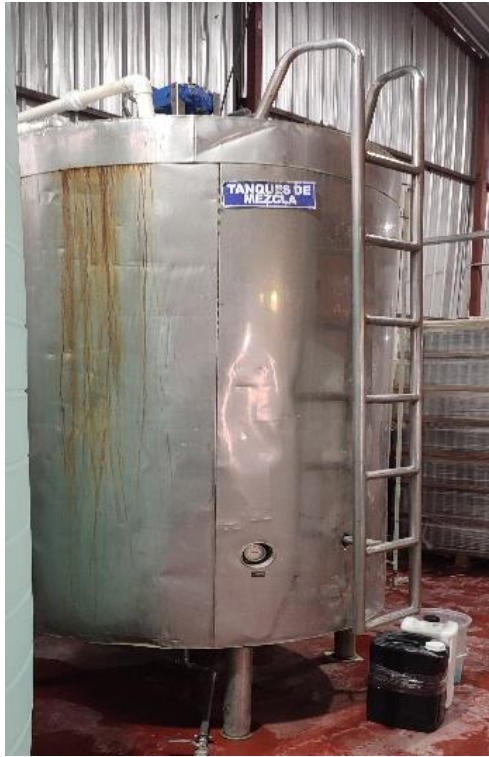
Figura - 7 - Tanque se mezcla con capacidad de 5000 L
