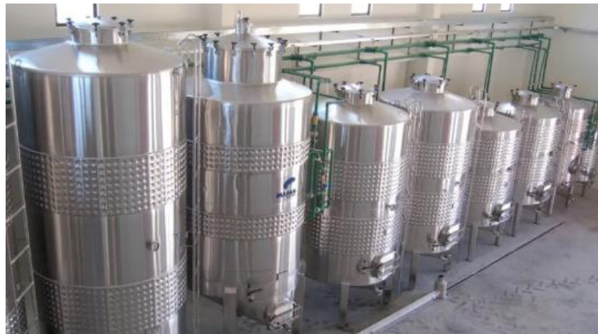
Figura 11: Tanques con chaquetas en forma de hoyuelos
