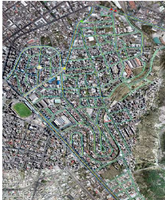
Gráfica 176 Representación en el software ArcGIS de las fallas encontradas tipo Agrietamiento Longitudinal según su nivel de Severidad Fuente: Daniela Leyton (2023)
