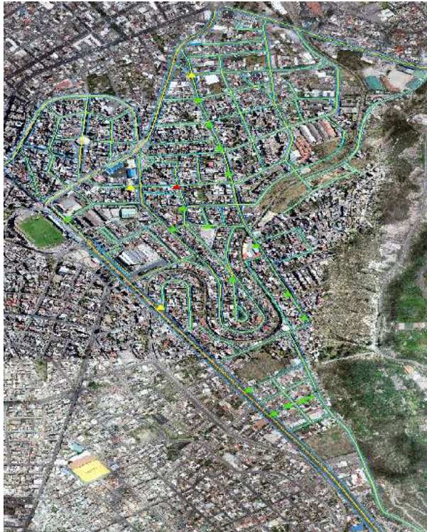
Gráfica 158 Representación en el software ArcGIS de las fallas encontradas tipo Grietas Longitudinales y Transversales según su nivel de Severidad Fuente: Daniela Leyton (2023)
