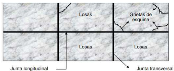
Gráfica 81 Grietas de esquina
