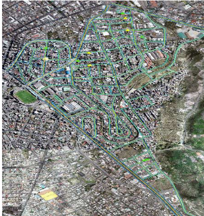
Gráfica 179 Representación en el software ArcGIS de las fallas encontradas tipo Abultamiento según su nivel de Severidad Fuente: Daniela Leyton (2023)
