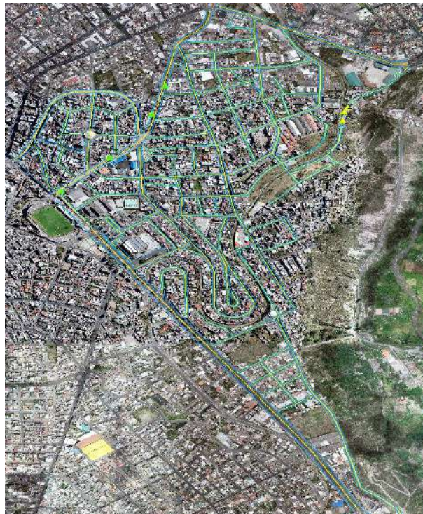
Gráfica 173 Representación en el software ArcGIS de las fallas encontradas tipo Agrietamiento Transversal según su nivel de Severidad Fuente: Daniela Leyton (2023)
