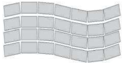
Gráfica 96 Desplazamiento de Juntas Fuente: C. Higuera. y O. Pacheco, Patología de pavimentos articulados-2010
