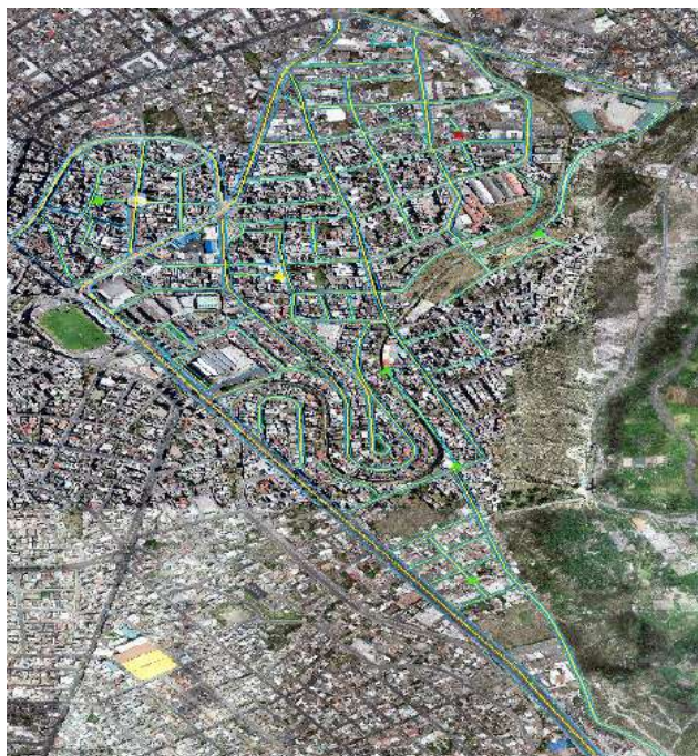
Gráfica 194 Representación en el software ArcGIS de las fallas encontradas tipo Vegetación en la Calzada según su nivel de Severidad Fuente: Daniela Leyton (2023)
