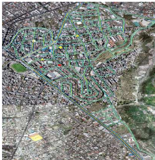
Gráfica 167 Representación en el software ArcGIS de las fallas encontradas tipo Huecos según su nivel de Severidad
