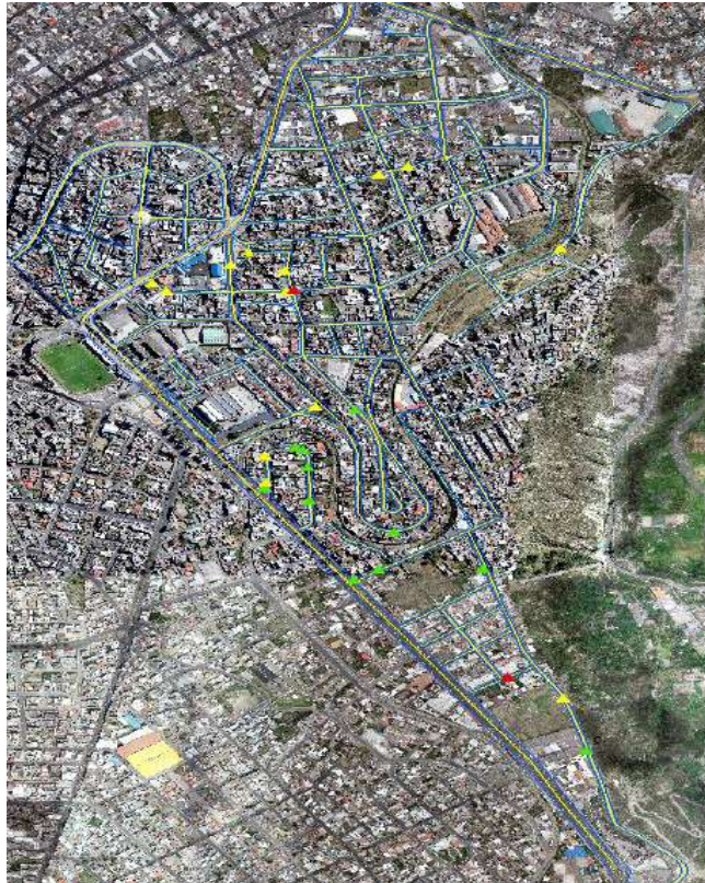
Gráfica 152 Representación en el software ArcGIS de las fallas encontradas tipo Agrietamiento en Bloque según su nivel de Severidad Fuente: Daniela Leyton (2023)
