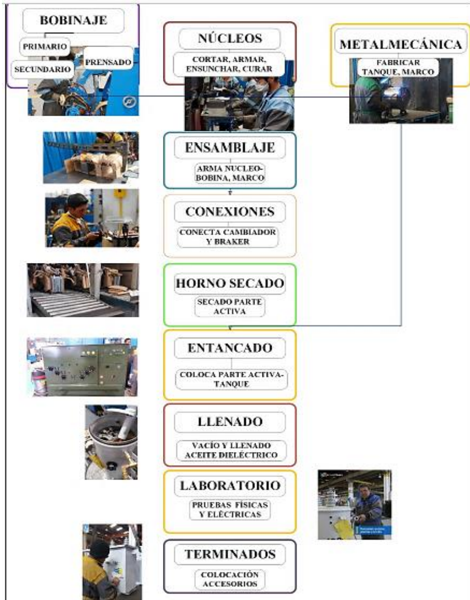
Figura 13: Esquema básico del proceso de fabricación de un transformador [31].
