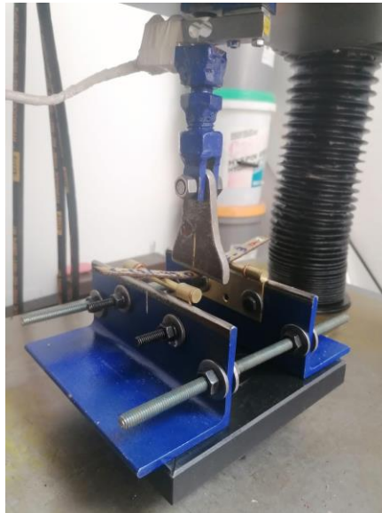
Figura 2.3.- Máquina Universal (WAW600B) para ensayos de flexión.
