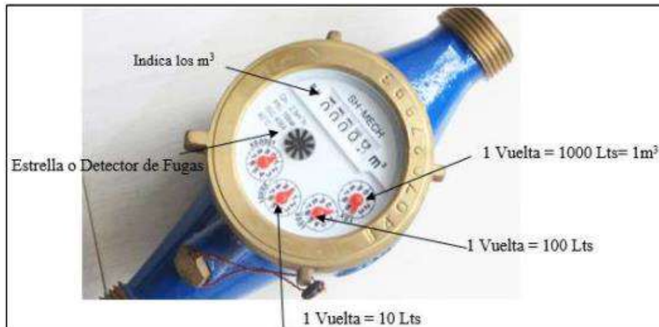
Figura 13: Interpretación de marcación de un medidor DH meter
