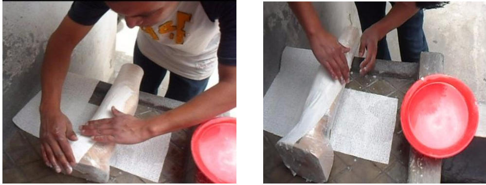
Fig. 6.12. Primera capa de yeso en el molde.
