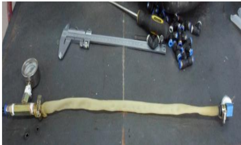
Fig. 4.14. Prueba de resistencia a la presión en la manguera de látex producida industrialmente, sin recubrimiento.
