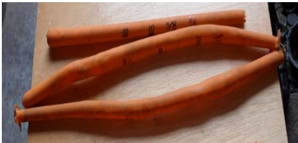
Fig. 4.15. Mangueras de látex construidas en taller.
