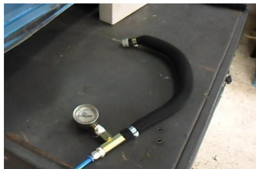
Fig. 4.5. Prueba del revestimiento de tela tipo licra a una presión de 50 psi, y con un diámetro de 20mm.
