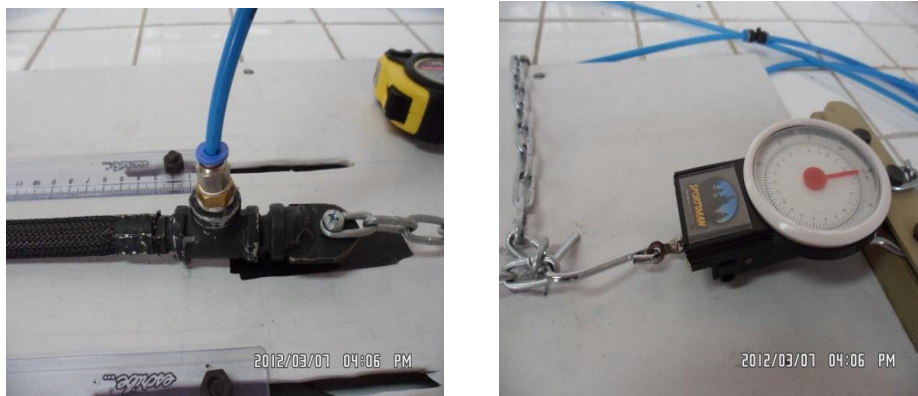
Fig. 3.18. Sujeción del extremo del musculo neumático, al extremo del dinamómetro.
