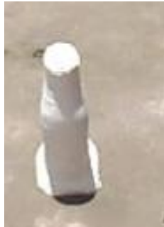
Fig. 6.14. Secado del molde de yeso.
