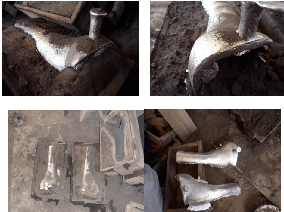
Fig. 6.23. Desmoldado de la fundición de la férula.
