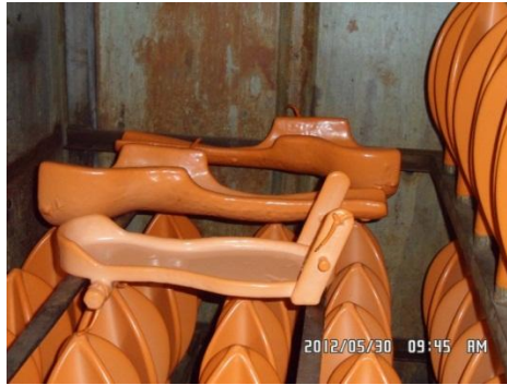
➤ Fig. 6.29. Recubrimiento de látex de la férula y plantilla del equipo.
