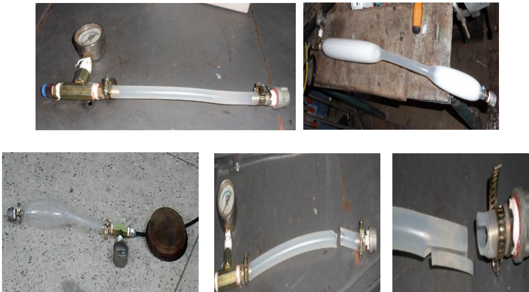
Fig. 4.13. Ruptura de la manguera de silicón grado 3.
