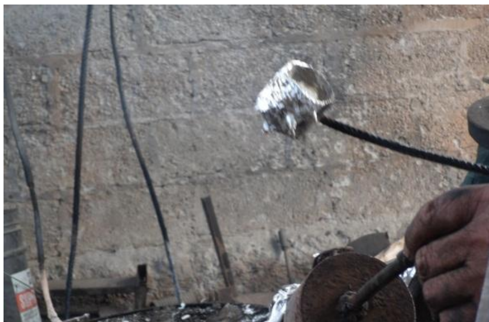
Fig. 6.22. Colado del aluminio líquido en moldes.
