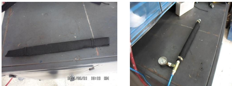
Fig. 4.7. Prueba del revestimiento de plancha de elástico reforzado utilizado en la confección de fajas de seguridad a una presión de 30 psi, y con un diámetro de 20mm.
