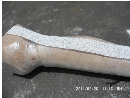
Fig. 6.11. Cortes de las vendas de yeso para cubrir el molde.
