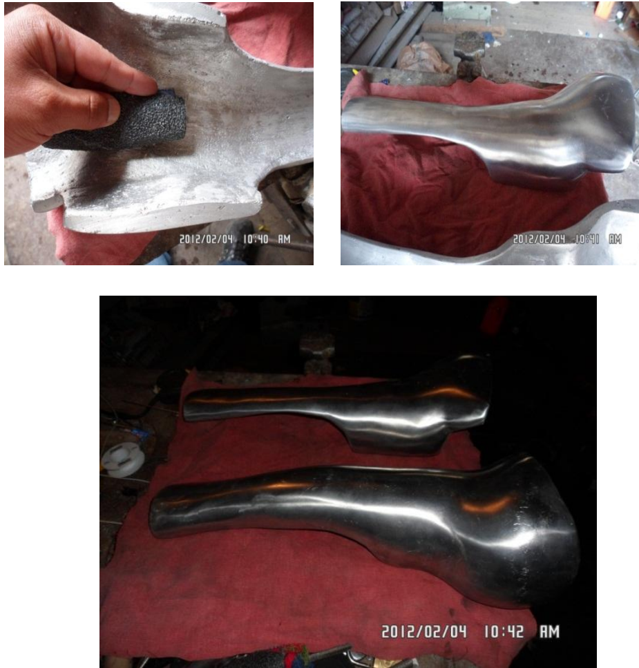
Fig. 6.25. Pulido total de la férula de aluminio.
