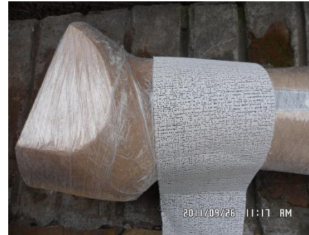
Fig. 6.11. Cortes de las vendas de yeso para cubrir el molde.
