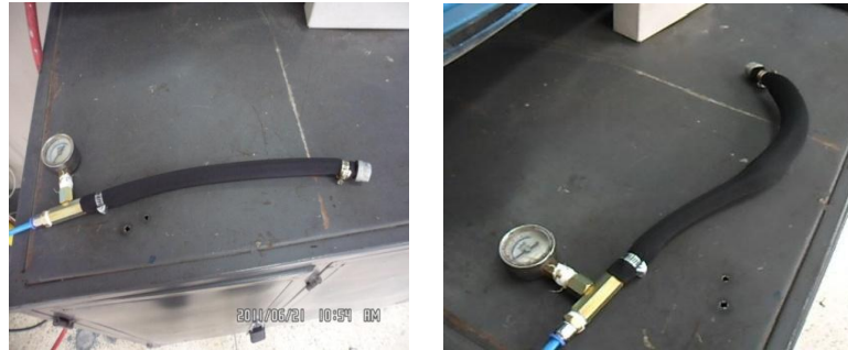
Fig. 4.4. Prueba del revestimiento de tela tipo licra a una presión de 30 psi, y con un diámetro de 20mm.
