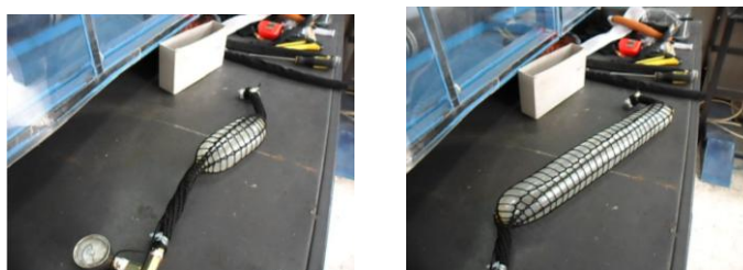
Fig. 4.11. Prueba del revestimiento de elástico reforzado con hilo una presión de 30 psi.
