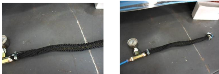
Fig. 4.10. Prueba del revestimiento de elástico reforzado con hilo una presión de 20 psi.
