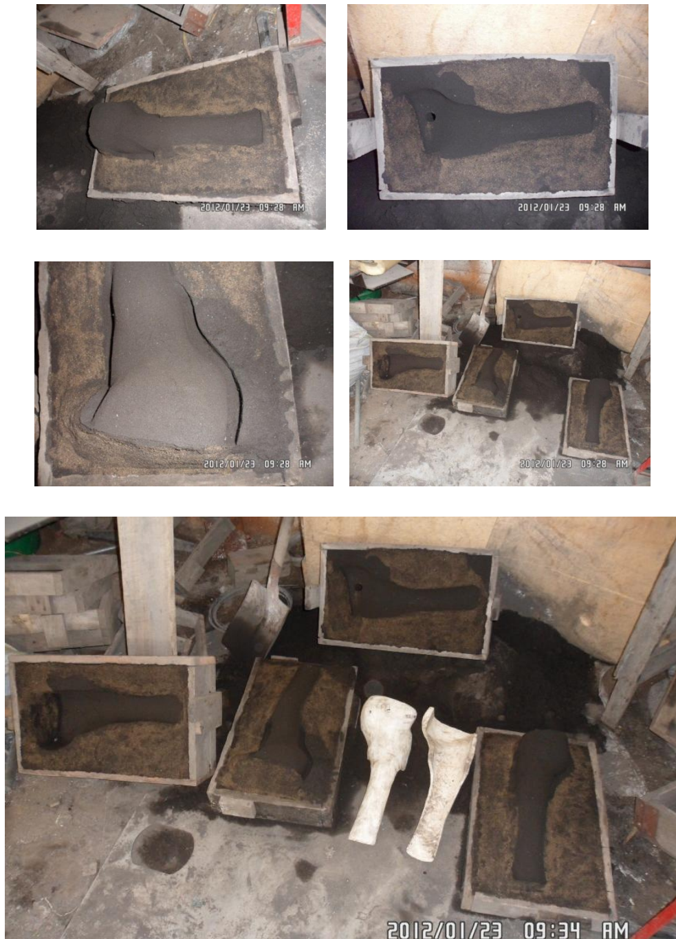
Fig. 6.20. Férula moldeada en arena.
