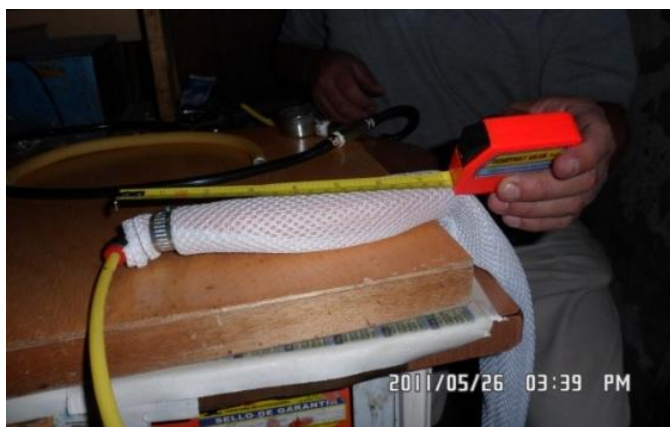
Fig. 4.1. Toma de medida de desplazamiento longitudinal, al revestimiento de tela mallada de poliéster con una presión de 25 psi, y diámetro de 25mm.
