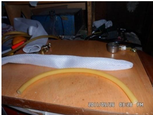
Fig. 3.2. Recubrimiento de tela mallada de poliéster.
