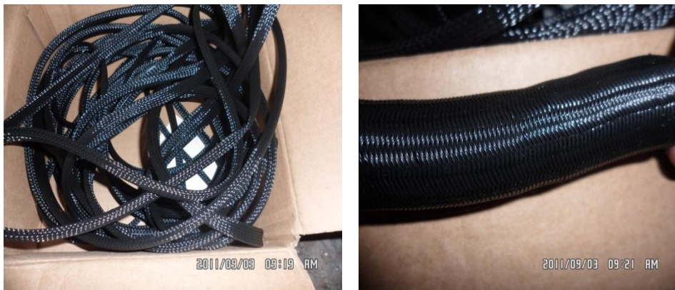
Fig. 3.6. Recubrimiento de manga trenzada de poliéster tipo PET.
