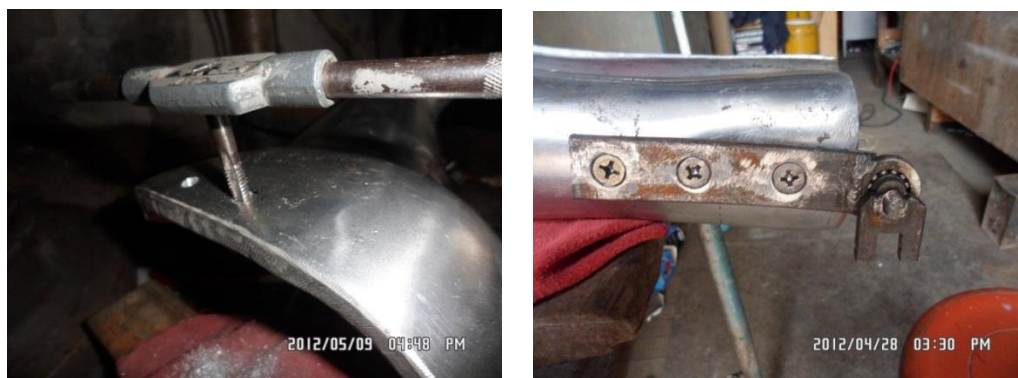
Fig. 6.27. Perforaciones y roscados en la férula.
