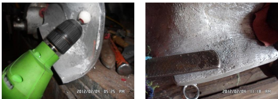
Fig. 6.24. Rectificado de la férula de aluminio.
