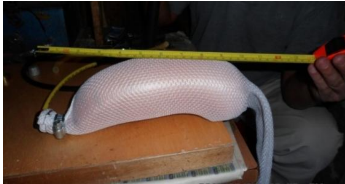
Fig. 4.2. Toma de medida de desplazamiento longitudinal, al revestimiento de tela mallada de poliéster con una presión de 30 psi, y diámetro de 45 mm.
