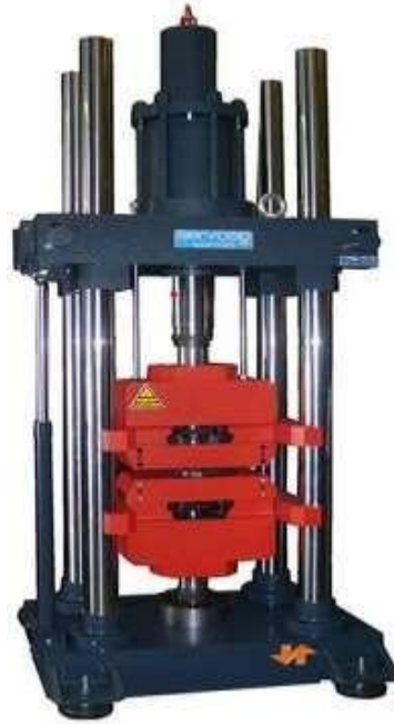
Figura 2.3. Máquina universal de ensayos para tracción
