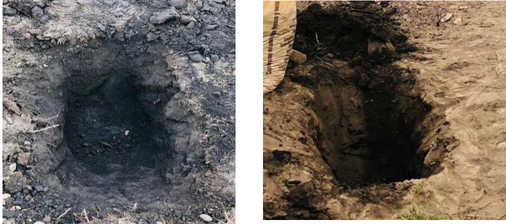
Figura 25: Calicatas realizadas en campo
