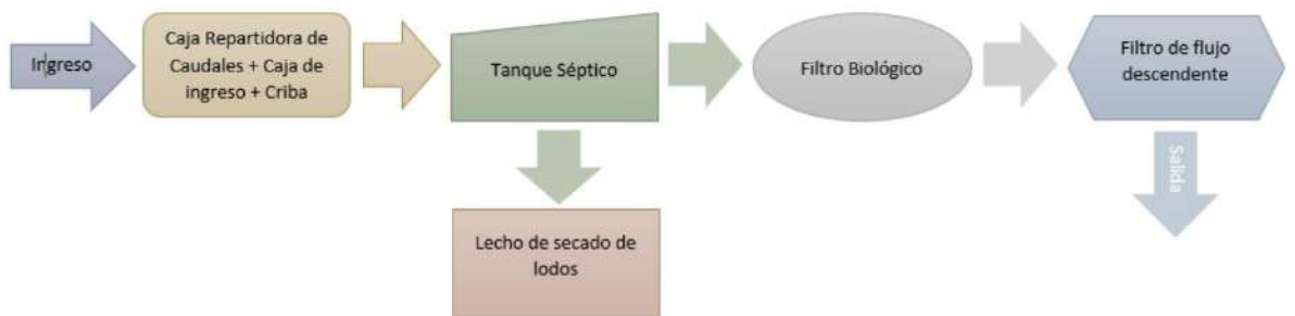
Gráfico 31 Diagrama del proceso de tratamiento P.T.A.R. Cacahuango
