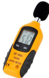
Figura 6. Sonómetro Hti HT-80A SOUND LEVEL METER
