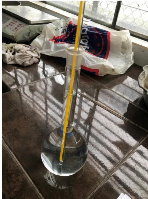
Figura 26. Picnómetro con agua y termómetro
