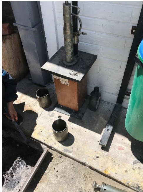
Figura 23. Elaboración de Briquetas
