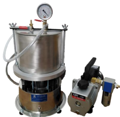
Figura 13. Máquina extractora de vacíos – Para ensayo rice Rice
