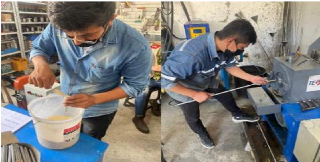
Figura 16. Proceso de compactado: a) Relleno del tubo de acero inoxidable con oxido de magnesio; b) Compactado de la resistencia
