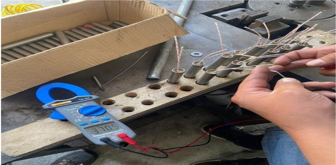
Figura 17. Medición de la potencia de las resistencias
