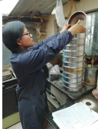
Anexo F-67 Pasar las pruebas de suelos por la serie de tamices.
