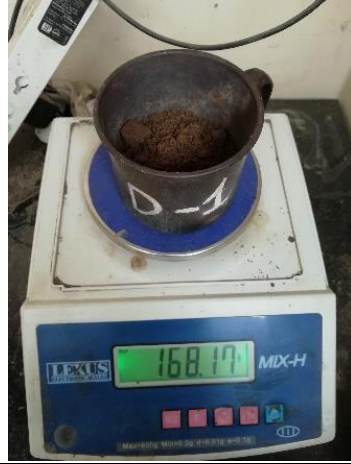
Anexo F-61 Peso del recipiente más la muestra del suelo húmedo.
