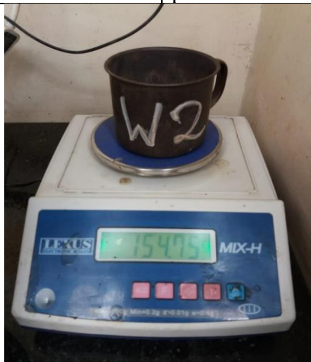
Anexo F-98 Toma de muestra para contenido de humedad.
