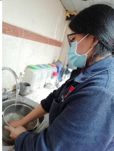
Anexo F-65 Lavando la muestra con ayuda del tamiz #200 y agua potable
