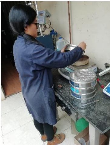
Anexo F-68 Pesando las muestras de los pesos retenidos en cada tamiz.
