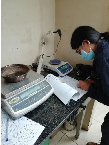
Anexo F-64 Pesando la muestra de suelo de 500g aproximadamente.
