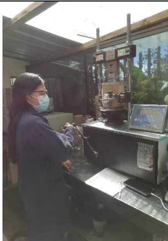
Anexo F-97 Realizando el ensayo de penetración.
