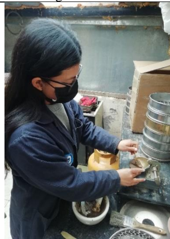
Anexo F-75 División de la muestra con ayuda del ranurador.
