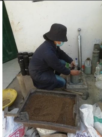
Anexo F-91 Colocando la primera capa de suelo.
