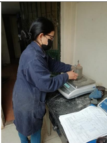
Anexo F-86 Pesar el molde más la muestra de suelo.
