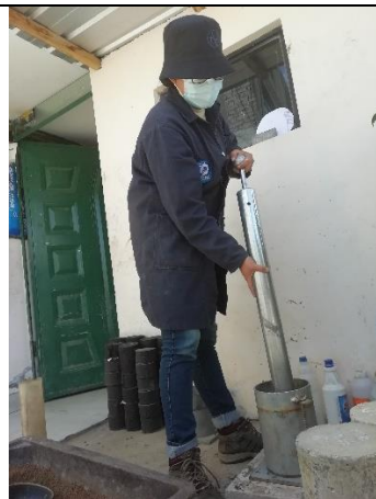
Anexo F-92 Apisonando la capa de suelo con 56 golpes por capa.
