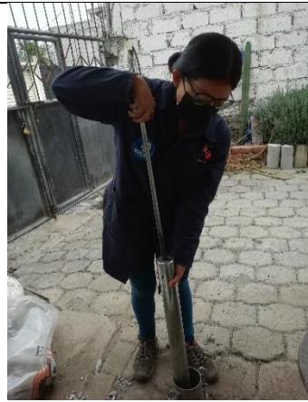
Anexo F-85 Apisonando la capa de suelo con 25 golpes por capa y usando el martillo de 10lb.
