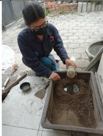
Anexo F-90 Adicionando agua a la muestra de suelo.
