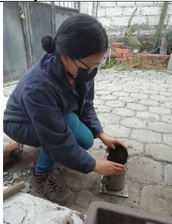
Anexo F-84 Colocando la primera capa de suelo.
