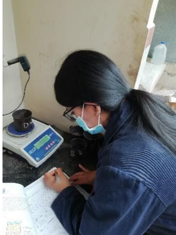
Anexo F-63 Peso del recipiente más la muestra de suelo seco.
