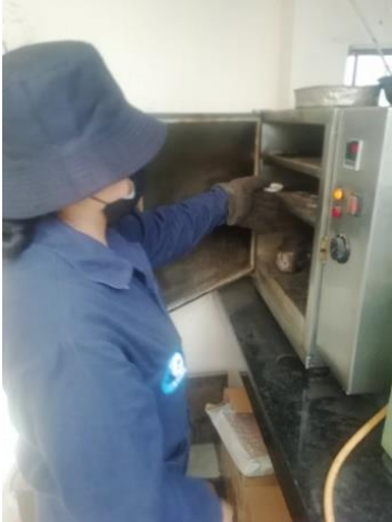
Anexo F-62 Colocación de los recipientes en el horno.
