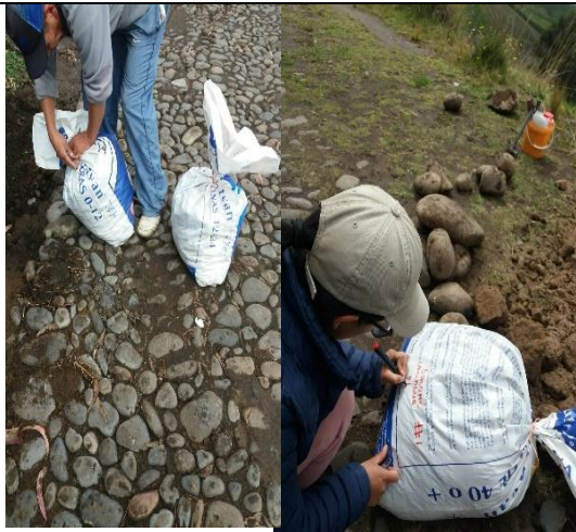
Anexo F-57 Etiquetado de las muestras de suelos de cada calicata.
