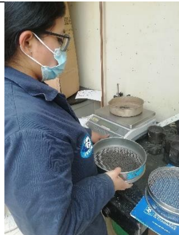
Anexo F-69 Pesando las muestras de los pesos retenidos en cada tamiz.
