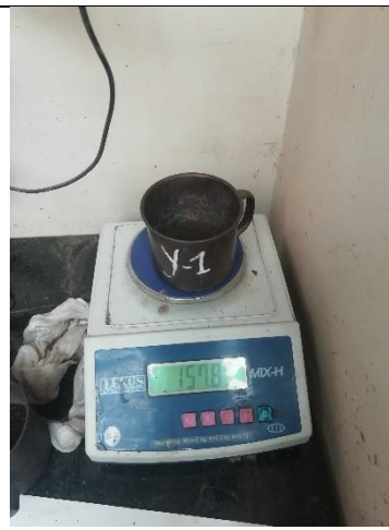
Anexo F-87 Sacando muestras para el contenido de humedad y pesándolas.
