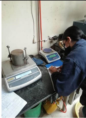
Anexo F-94 Pesando el molde más la muestra de suelo.
