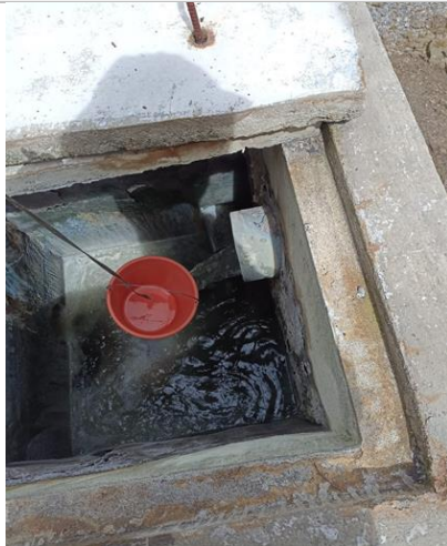
Figura 47. Medición de caudales de ingreso a la P.T.A.R por el método volumétrico.
