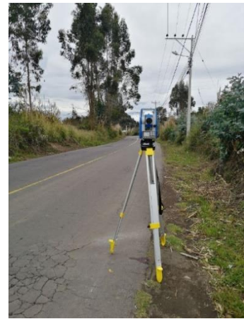
Figura 42. Levantamiento topográfico con estación total de la red existente.
