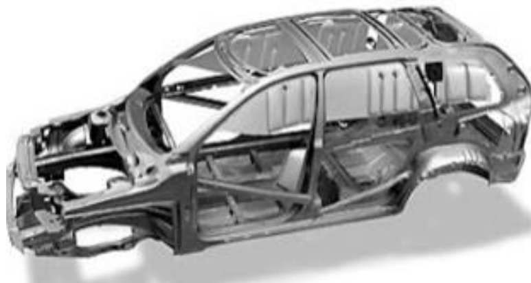
Figura 9: Carrocería de chasis autoportante
