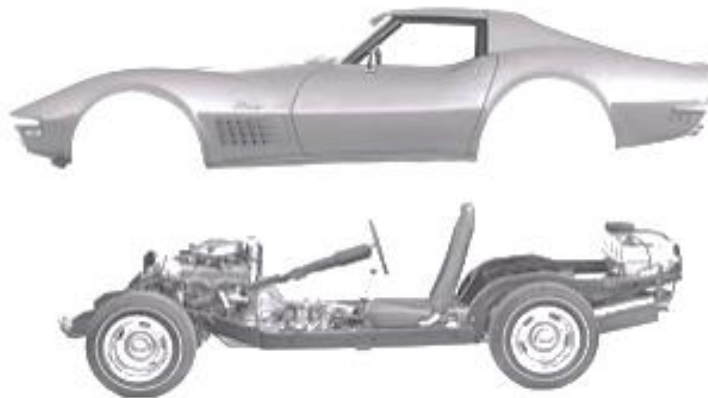
Figura 8: Carrocería de chasis independiente
