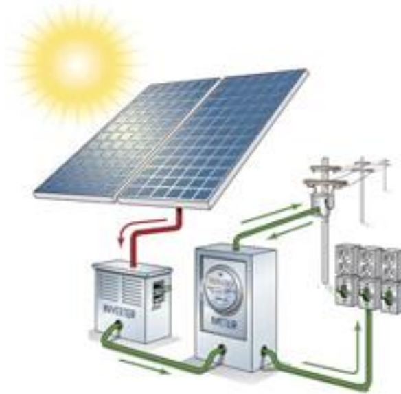
Figura 2-2: Sistema fotovoltaico conectado a la red (Villegas y Alcivar 2020).
