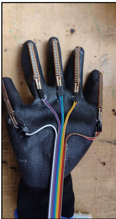
Figura 21 Guante conectado a los sensores mediante cables dupont
