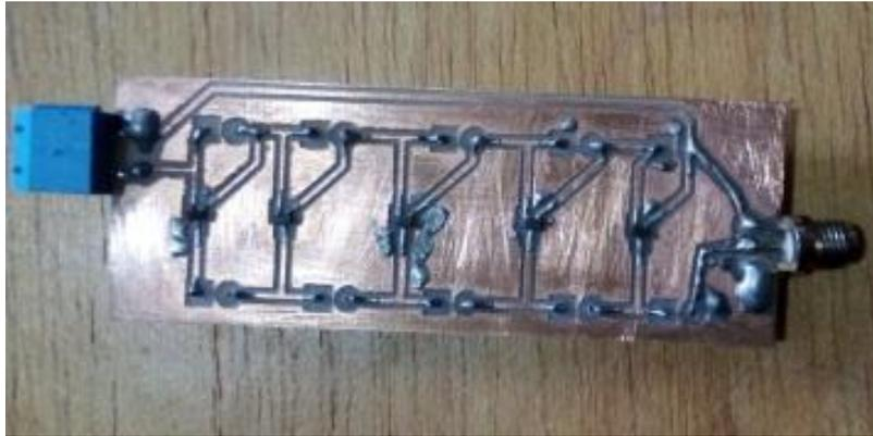
Figura 41. Placa en baquelita de cobre.
