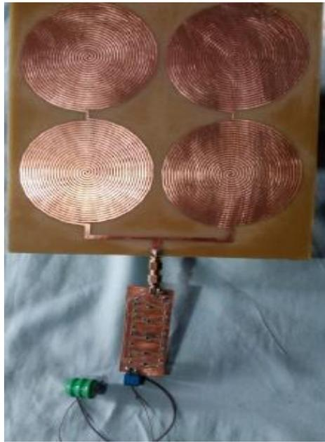
Figura 48. Salida de voltaje directa empleando la matriz de rectenna logarítmica espiral.
