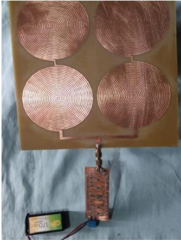
Figura 47. Salida de voltaje directa empleando la matriz de rectenna logarítmica espiral.
