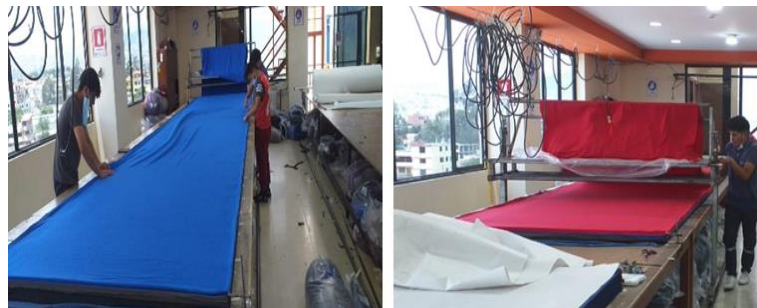
Figura 19.- Tendido de tela.
