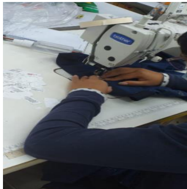
Figura 27.- Proceso de colocado de elástico.
