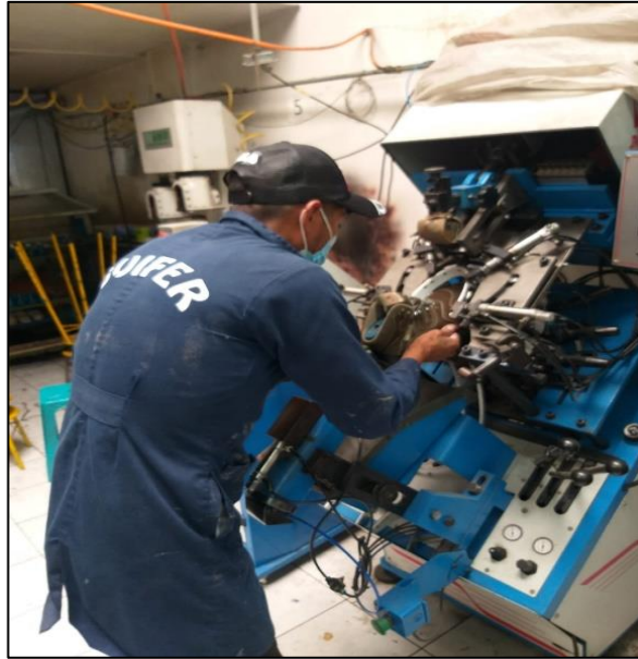
Figura 23 Armado de puntas
